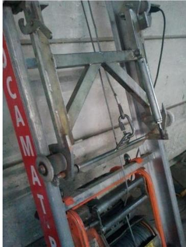
Sécurisé depuis une échelle ou un échafaudage monter le câble jusqu'à la poulie supérieure. Suivre le sens des flèches. Refermer le cache poulie.
